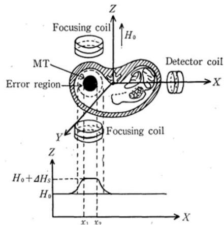
北海道大学応用電気研究所の阿部善右衛門らは、非線形傾斜磁場を使った磁場焦点法を用いて、生体内の局所領域のNMR信号の収集に成功した。NMRによる生体計測の先駆的な研究である。
