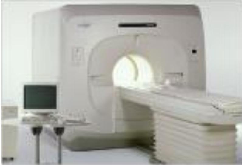
計算機系に64bit RISCプラットフォームを採用し、X-windowを使ったソフトウェア及びデジタル高周波回路、強度を増した傾斜磁場系など、従来の性能を一新した1.5T MRIシステム。1995年にはグッドデザイン賞を受賞した。
