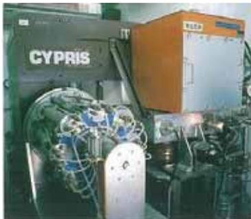
写真2：住友重機械製 CYPRIS325型の初号機。加速エネルギーは陽子15MeV、重陽子7.8MeV。ターゲットは1ポートに8連のリボルバータイプのターゲットが装着された。京都大学附属病院納入（1982年）。
